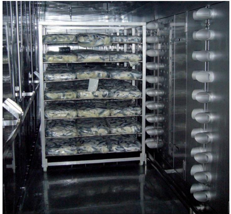
D'une haute technicité, le procédé de DÉCONGÉLATION PAR VENTILATION D'AIR CHAUFFÉ ET SATURÉ EN HUMIDITÉ d'ARCOS ne manque pas d'atouts.
